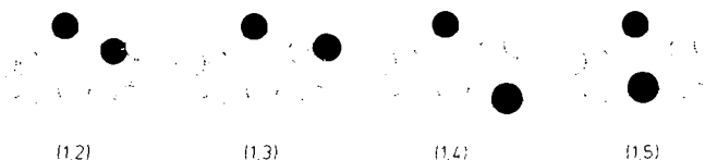
Abb. 8. Mögliche cyclische Strukturen von Se_2S_6 und Se_6S_2 . Die Zahlen in Klammern geben die Positionen des zweimal vorhandenen Elements an.
